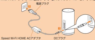
**■ 電源を切る****1 Speed Wi-Fi HOME ACアダプタの電源プラグをコンセントから抜く****2 本製品からSpeed Wi-Fi HOME ACアダプタのDCプラグをまっすぐ引き抜く****無線LAN(Wi-Fi<sup>®</sup>)で接続する**
